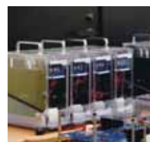
ユニット化されたリチウムイオン電池
