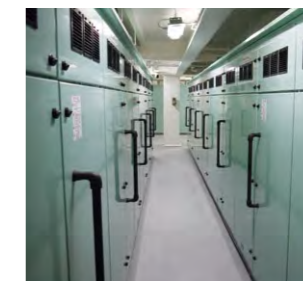
312本の蓄電池を1モジュールとし、20モジュールを組み込んだ電池ユニット52台が船底に搭載されている
