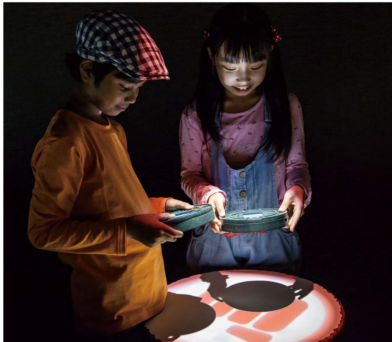
LED照明の光に石板型端末をかざすと位置情報を取得する
