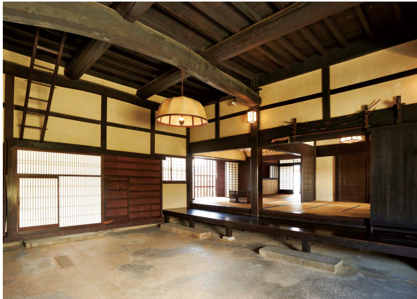
土間と隣り合って4つの居室が田の字型に並ぶ「四間取り」は農家型の造り。旧杉山家住宅はこれを原形とし、奥に複数の座敷を増築している
