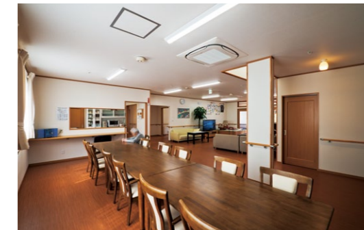
テクノビームにより、約70m 2 と広い空間が確保された食堂・居間 照明器具には一体型LEDベースライト iDシリーズを採用
