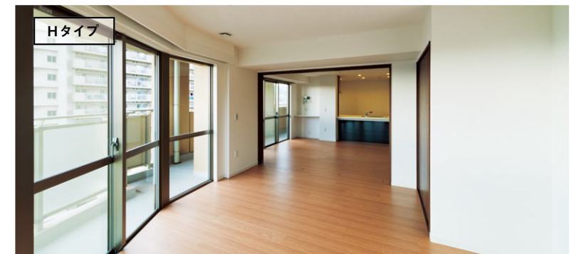
改修後 クローゼットを壁側に移動し、壁をスライディングドアにすることで1ルーム使用も可能に
