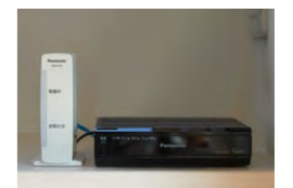
AiSEGと住宅機器コントローラ
