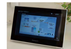
住宅機器コントローラ用モニター
