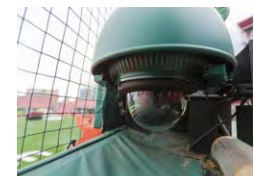
戦略分析システムに使われる 全天候型4Kドームカメラ
