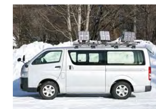
投光器と蓄電池を搭載した照明車
