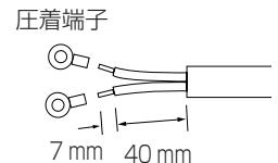
圧着端子は、漏電しゃ断器に取り付けられています。
