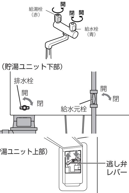
3 排水栓から水（お湯）が出なくなったのを確認して、混合水栓の給湯栓（赤）、排水栓を閉じる
