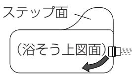
●必ず、ステップの反対側にお湯が吹き出しますよう、取り付けてください。(温度むらが発生)
