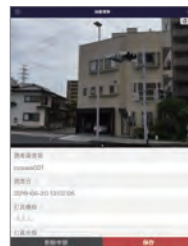
タブレット型の現地調査をサポートするアプリケーション。道路灯の台帳情報と、位置図や写真などの図面情報を一元的に管理することができます。
