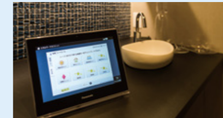
プライベート・ピエラ(住宅機器コントローラーモデル)。普段は足元灯として、停電時は家の中のすべての機器をこのモニターひとつで操作可能。AiSEGと連動してエネルギーの「見える化」も。
