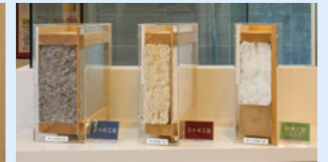
「2×6」「2×4」「在来工法」の違いを現物の断面を使用してご来場者に説明されています。
