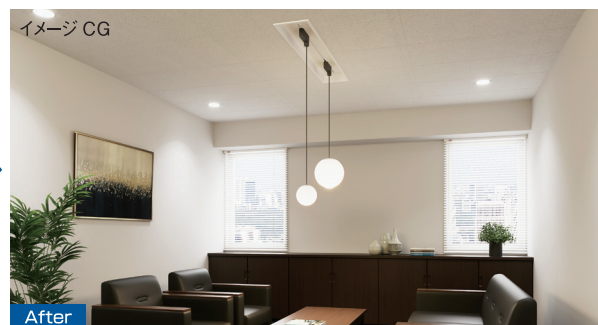
色温度を 3500K（温白色）に変更し、ペンダントを取り付けることで雰囲気ががらりと変わった応接室
