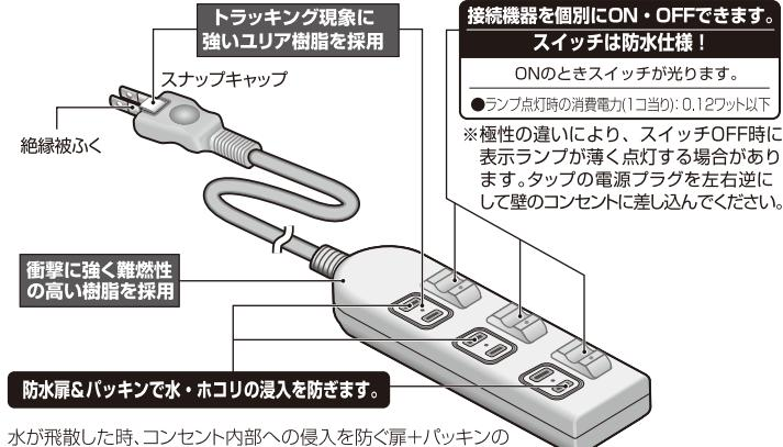
水が飛散した時、コンセント内部への侵入を防ぐ扉+パッキンの防水性能は、当社独自の下記試験条件で評価しています。
