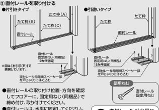
●直付レールは、水平に固定してください。 ※直付レールの納まりは、表面[製品寸法図と納まり]を 参照してください。
