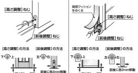
●調整ねじの部分を⊕ドライバーを使用して調整をしてください。 ●調整後、再度ソフトクローズが正常に作動するか、ご確認ください。
