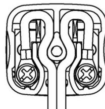
カバーを被せて組立ねじを 0.5 N・m ~ 0.8 N・mのトルクで締付ける。
