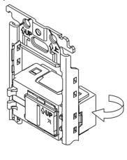
(注) 必ず『左側』から挿入してください。スイッチ本体『右側』に設けてある突起から 先に挿入すると、取付られなくなりますので、ご注意ください。
