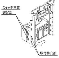
(2) スイッチ本体を取付枠の穴部にスイッチ 本体『右側』の突起が入るまで、上へ押し あげる。
