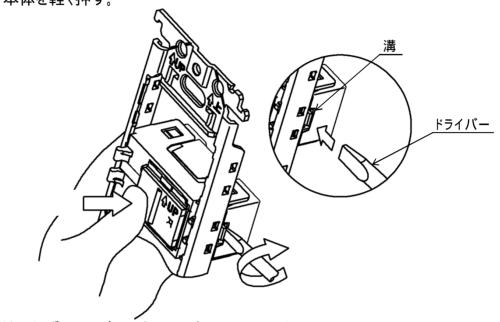
(注) 必ずドライバーを押しながら、回して下さい。 ドライバーを単に押すだけでは、器具ははずれません。
