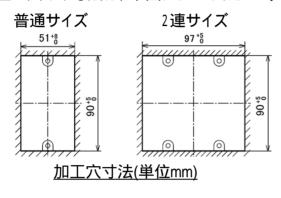
(注1) II S適合以外のスイッチボックスを用いますと、ボックスカバーの穴の四隅に取付枠の垂下部(下図)が当たり入らない場合があります。
