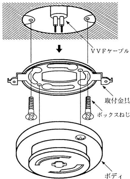
① 取付金具のみボックスねじでボックスに固定してください。
