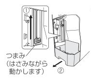
※トレーはつまみ(電極ユ ニット)を引き上げな いと取り出せません。 必ず電極ユニットが上 がっていることを確認 してから、トレーを取 り出してください。
