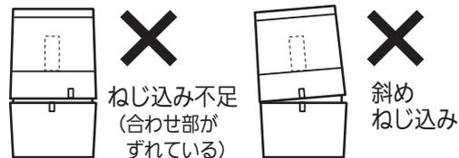
**警告** **!** カバーは確実に取り付ける 締め付けが不完全な場合、浸水による感電のおそれがあります。必ず守る
