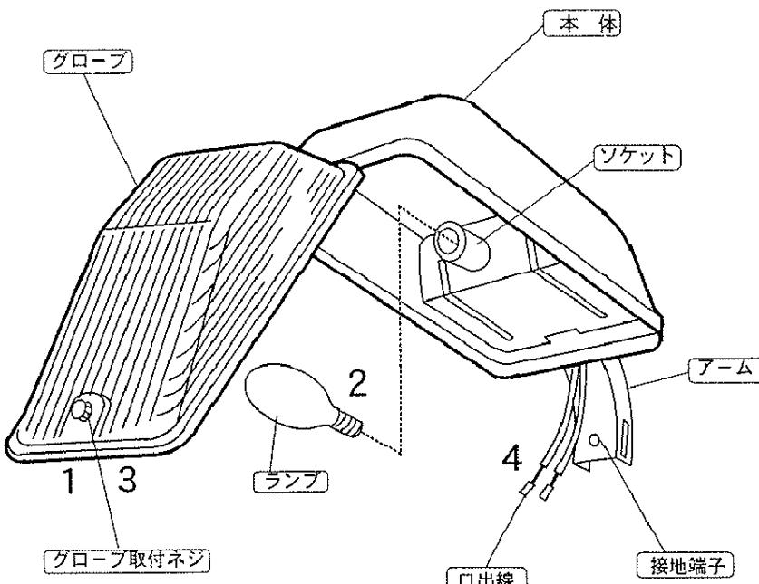
2 同様のランプをソケットに確実にねじ込む
