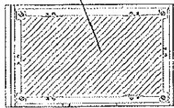
本体を設置する箇所（斜線部）にモルタルが残らない様に処理して下さい。
