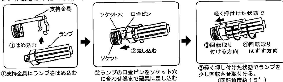
④取りはずす場合には、軽く押し付けながら取付と逆方向に回転させてください。
