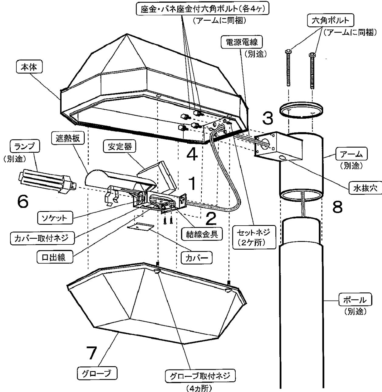
5 接続部をスリーブ等で結線後、自己融着テープで処理し、絶縁テープでテープングする。
