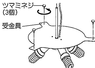
②セードの固定金具と受金具を下図の位置に合わせ、セードを上に持ち上げる。
