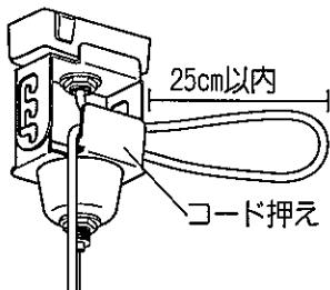
②コードを巻き付け、最終部をコード押えに押し込む。
