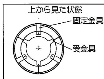
③セードを回し、セードの固定金具を受金具の上にのせ、ツマミネジ(3個)でセードを取り付ける。
