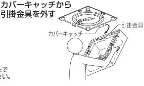
ランプの明るさが低下したり、 点滅をくり返したりするようになると寿命です。 ランプを交換してください。
