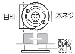
天井に下図のような配線器具が付いている場合、取り付けできます。 2 の作業へ進んでください。
