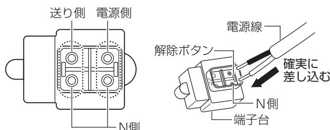
器具の取り替え等で電源線を外す場合は、マイナスドライバー等で解除ボタンを押しながら電源線を引き抜く。
