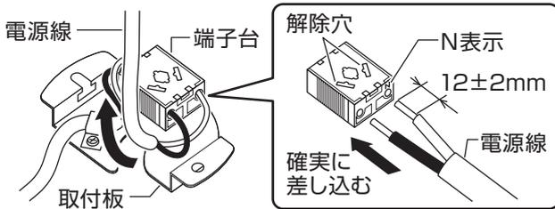
・電源線差し込み後、取付板の中央にくるように電源線を曲げてください。
