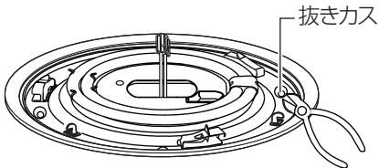
③対向するノックアウト穴に木ネジ\*2本で支持具(2個)を取り付ける
