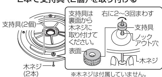
④①～④を行なった後、木ネジ\*2本で補強材のある場所に取り付ける。
