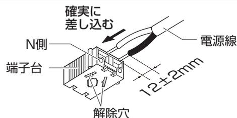
器具の取り替え等で電源線を外す場合は、マイナスドライバー等を解除穴に差し込みながら電源線を引き抜く。
