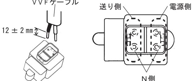
器具の取り替えなどで電源線を外す場合はマイナスドライバーなどで解除ボタンを押しながら電源線を引き抜く。
