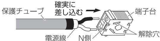
器具の取り替え等で電源線を外す場合は、マイナスドライバー等を解除穴に差し込みながら電源線を引き抜く。
