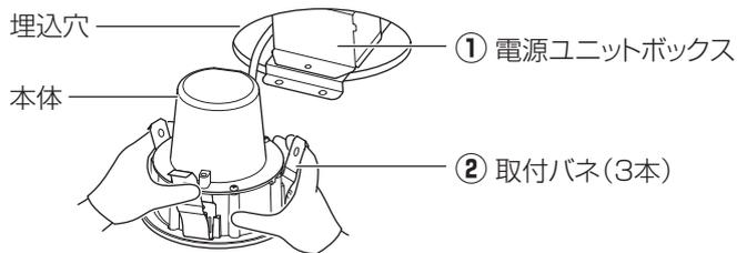
●石こうボードに取り付けた器具を取り外す場合は、枠部をゆっくり引き下げて取付バネ(3本)を押し曲げながら取り外してください。取り外しに不備があると、天井材破損の原因となることがあります。
