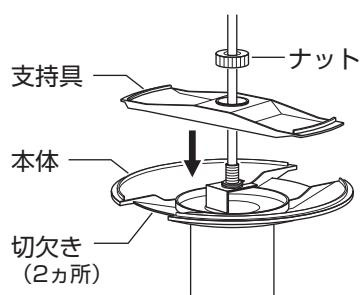
②本体の切欠き（2ヵ所）にカバー開口部を沿わせながら、カバーを取り付ける。
