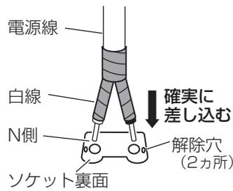
器具の取り替え等で電源線を外す場合は、φ1.6の単線を解除穴に差し込みながら電源線を引き抜く。
