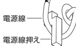
器具の取り替え等で電源線を外す場合は、マイナスドライバー等を解除穴に差し込みながら電源線を引き抜く。
