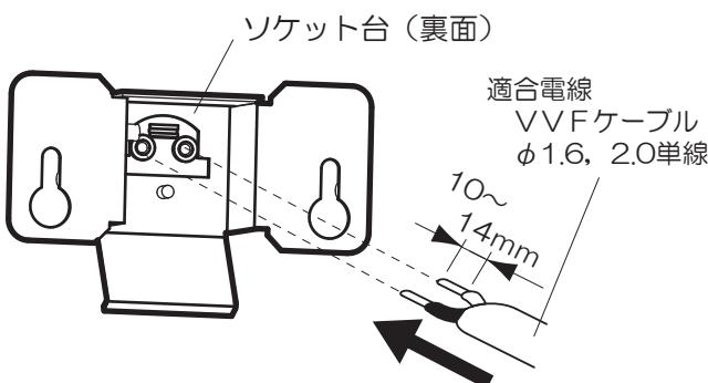
器具の取り替えなどで電源線を外す場合は、マイナスドライバーなどで解除ボタンを押しながら電源線を引き抜く
