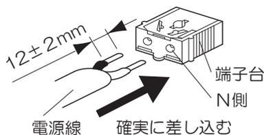
器具の取り替えなどで電源線を外す場合は、解除穴（2カ所）をマイナスドライバーなどを解除穴に差し込みながら電源線を引き抜く。
