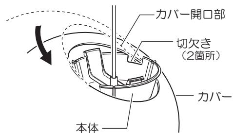
③カバーを持ち上げながら支持具を回転させ本体の切り欠きに入れる。
