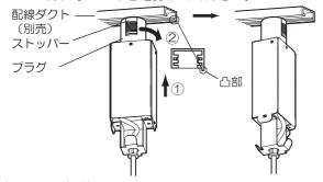
(取り外し方法) プラグのストッパーを押し下げて、左に90°回転させる。
