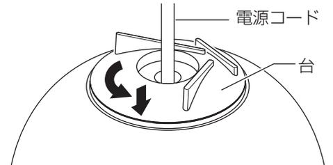
③ 電源コードを持ち本体を持ち上げた状態でナットを右に回して締め付ける。
