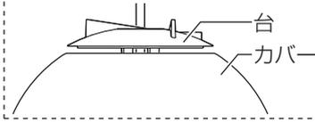
② 電源コードを持ち本体を持ち上げた状態で台を少し左に回して下におろし、本体にはめ込む。
