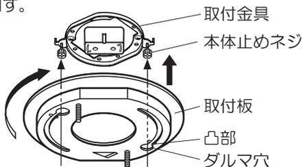
③ドライバーで本体止めネジを締め付ける
