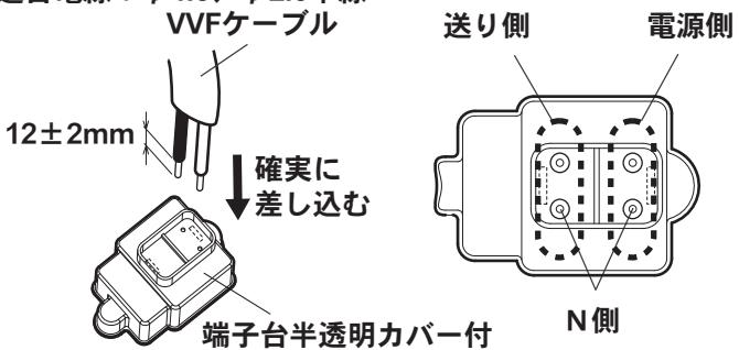
器具の取り替えなどで電源線を外す場合はマイナスドライバーなどで解除ボタンを押しながら電源線を引き抜く。
