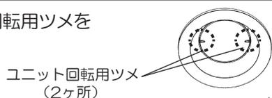
②LEDユニットのツメ(2ヶ所)を指で、矢印方向に回転させる。
