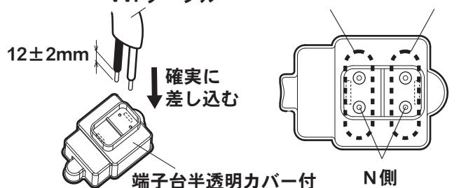
器具の取り替えなどで電源線を外す場合はマイナスドライバーなどで解除ボタンを押しながら電源線を引き抜く。
