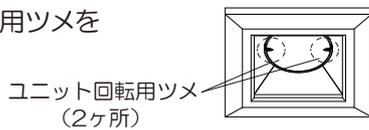
②LEDユニットのツメ(2ヶ所)を指で、矢印方向に回転させる。
