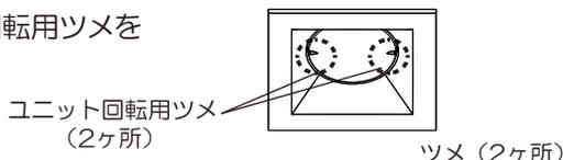
②LEDユニットのツメ(2ヶ所)を指で、矢印方向に回転させる。
