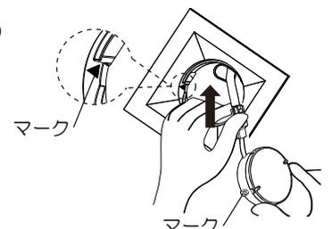
④LEDユニットを器具底面に押し当てる。LEDユニットのツメ(2ヶ所)を指で矢印方向に「カチッ」と音がするまで確実に回転させる。
