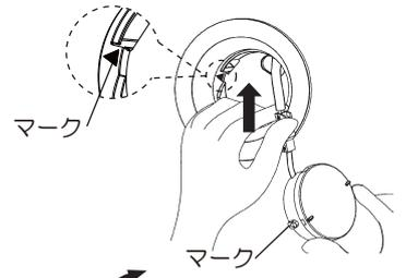
④LEDユニットを器具底面に押し当てる。LEDユニットのツメ(2ヶ所)を指で矢印方向に「カチッ」と音がするまで確実に回転させる。
