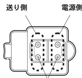
器具の取り替えなどで電源線を外す場合はマイナスドライバーなどで解除ボタンを押しながら電源線を引き抜く。
